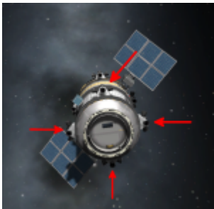
Sinnvolle Anordnung der RCS-Düsen (4 Steuertriebwerke an jeweils 2 Enden
